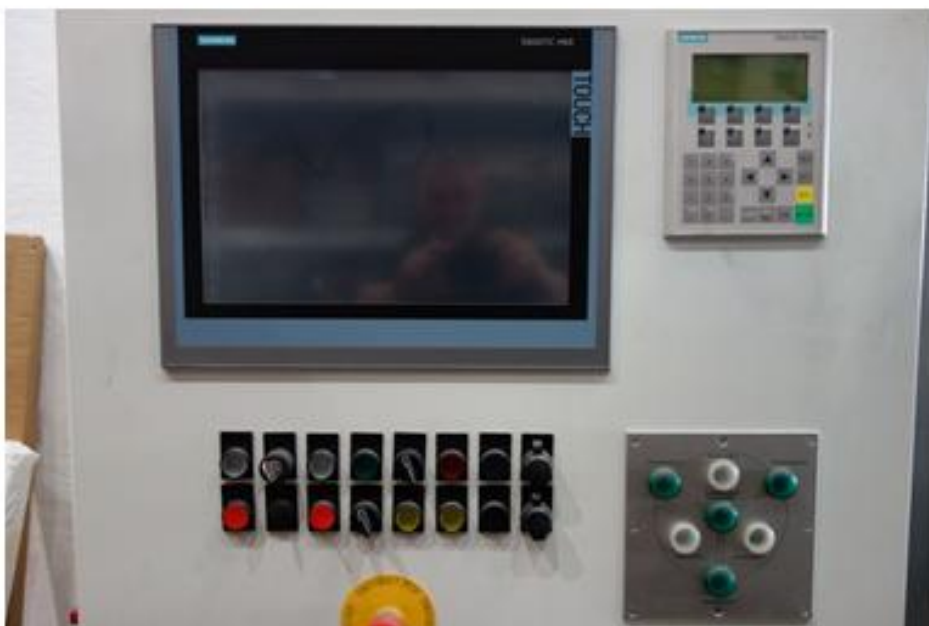
Painel de comando com botoeiras e interface homem-máquina
