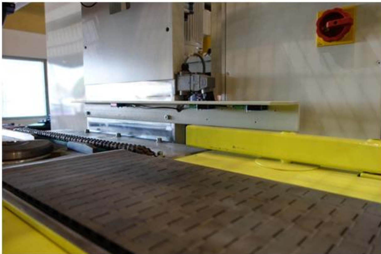
Sistema de transporte através de correntes com esteira (entrada)
